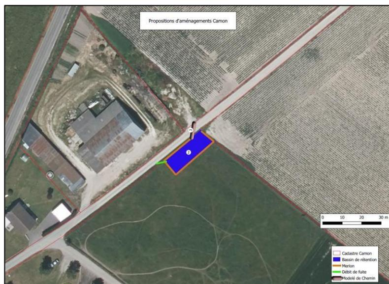
Création d'un ouvrage de stockage dans la parcelle cadastrale ZH 67. Le bassin aura une emprise de 25 mètres en longueur et 10 mètres en largeur (250 m<sup>2</sup>). Un merlon de terre d'une hauteur de 50 cm sera réalisé tout autour du bassin. Un débit de fuite de diamètre 150 mm sera installé en aval pour vidanger l'ouvrage. Le volume de stockage sera de l'ordre de 250 m<sup>3</sup>.
